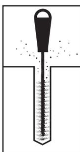
Éliminer les poussières avec une brosse métallique ou par soufflage (pompe soufflante manuelle ou air comprimé). Répéter l'opération 3 fois.
