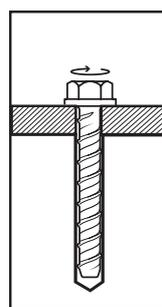
Visser la vis béton BETABOLT à travers la pièce à fixer, de préférence avec une visseuse/boulonneuse à chocs, en appliquant le couple de serrage  $t_{inst}$  suffisant.
