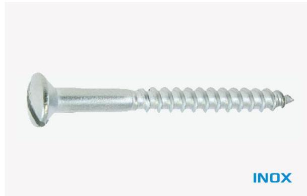
Les vis à bois DIN 95 ont une tête fraisée bombée avec une empreinte fendue. Elles sont utilisées pour tous les assemblages légers réalisés dans différents type de bois. Du fait de la forme spéciale de leur tête, ces vis sont le plus souvent visibles.
