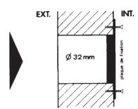
Présenter de l'extérieur, le CYLINDRE et la ROSACE et visser à fond, de l'intérieur, les 2 VIS d'assemblage (ces 2 vis préalablement coupées si nécessaire)
