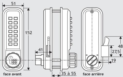
MODÈLE U2500 CS pêne en applique à crochet et clé de secours
