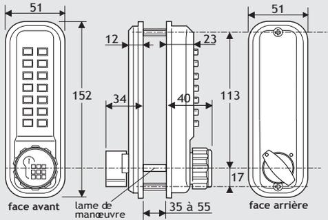
MODÈLE U2210 CS pêne dormant à larder et clé de secours
