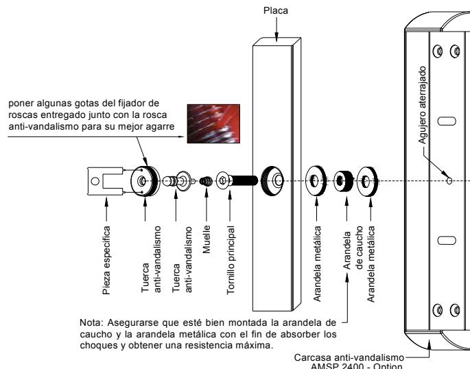
**El bloqueo correcto de la ventosa y de su contra placa está asegurado sólo si esta última está montada de manera FLOJA con la ayuda de la rodaja de caucho entregada con el material. Un tornillo central demasiado apretado y/o una tensión electrónica insuficiente son las dos causas que puedan provocar una falta de potencia de la ventosa.**
