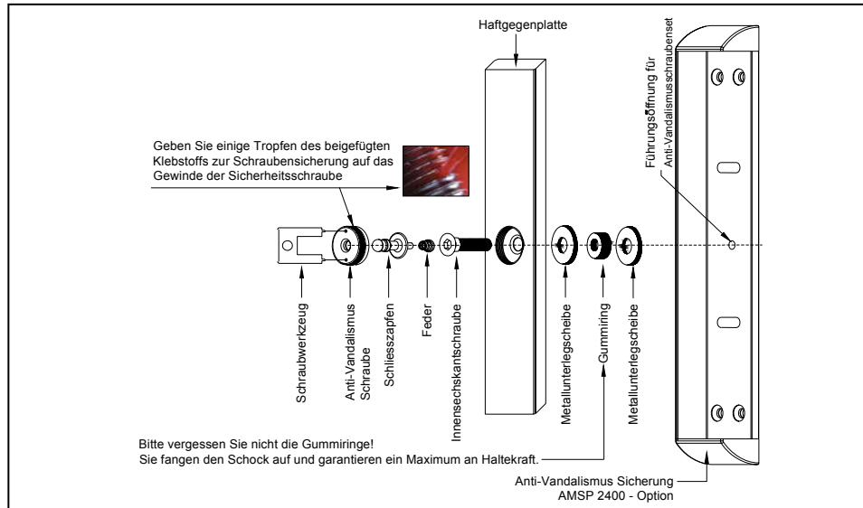
Die korrekte Verriegelung des Magneten und der Haftgegenplatte ist nur gewährleistet, wenn die Haftgegenplatte nicht zu fest sitzt und dank der Verwendung des mitgelieferten Gummirings in ihrer Achse noch beweglich ist. Eine Halteschraube, die zu fest zugezogen wurde und/oder eine zu schwache Klemmspannung am Haftmagneten sind die zwei Gründe, die eine Fehlfunktion hervorrufen können.
