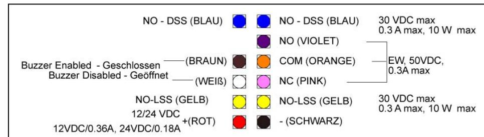
**Vergewissern Sie sich, dass die Kabel korrekt verdrahtet sind, bevor Sie den Strom einschalten, um eventuellen Schäden am Vortex® vorzubeugen.**
