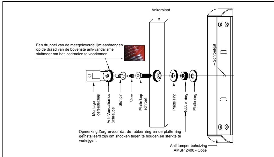
**Een correcte vergrendeling is slechts verzekerd als de ankerplaat met enige speling gemonteerd is en met behulp van de bijgeleverde rubberen ring. Een te vaste centrale schroef en/of onvoldoende elektrische spanning leiden tot een verminderde houdkracht van de elektromagneet.**
