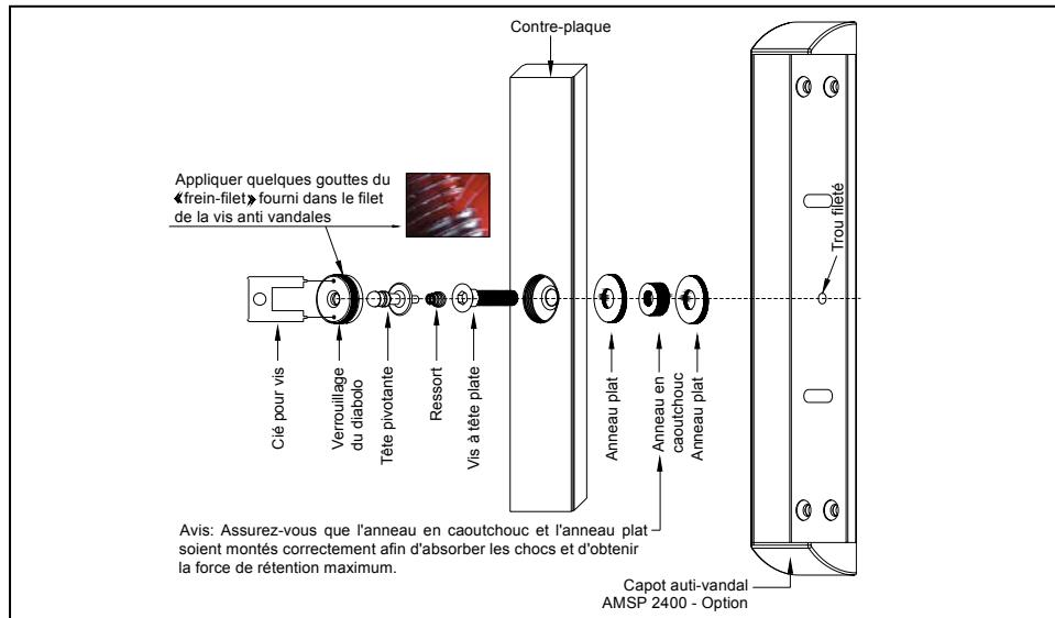
***Le verrouillage correct de la ventouse et de sa contreplaqué n'est assuré que si cette dernière est montée de manière SOUPLE à l'aide de la rondelle en caoutchouc fournie. Une vis centrale trop serrée et/ou une tension électrique insuffisante sont les deux causes entraînant un manque de puissance d'une ventouse.***
