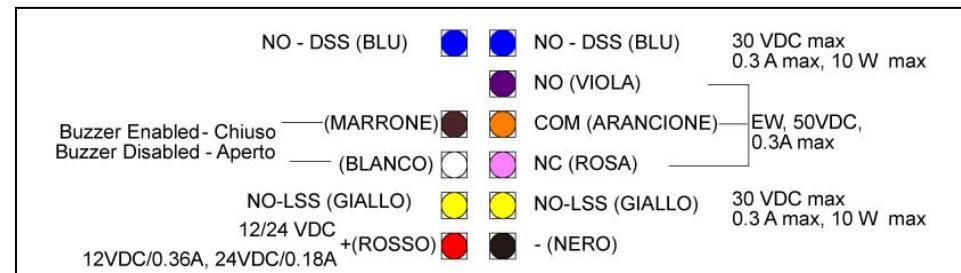
**Per evitare danni irreversibili, assicurarsi del buon collegamento prima di fornire corrente alla serratura.**
