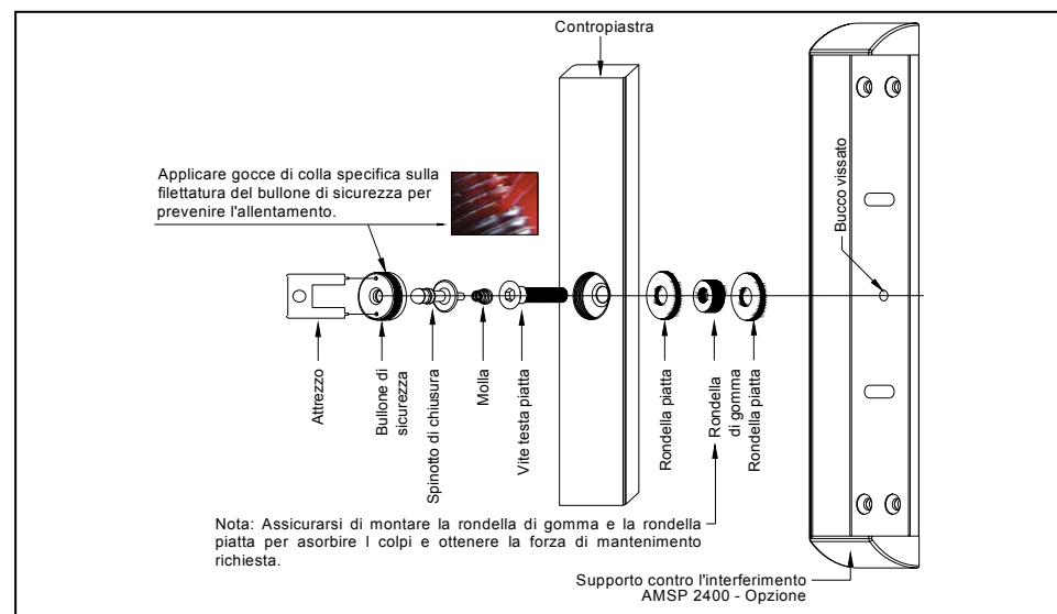
**Per assicurare una chiusura corretta del magnete e della sua contropiastra bisogna montare la contropiastre con FLESSIBILITÀ con l'aiuto della guarnizione di gomma fornita. Una vite troppo stretta oppure un'alimentazione non sufficiente sono le due principali cause del malfunzionamento del prodotto.**
