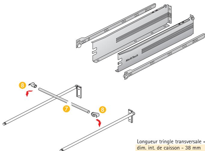
Longueur tringle transversale = dim. int. de caisson - 38 mm
