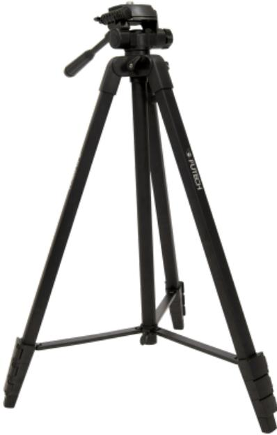
Trépied léger à pieds et tige télescopiques jusqu'à 240 cm de hauteur pour les lasers à ligne, lasers croix et lignes 3D et lasers croix et ligne. Tête inclinable (pour les pentes) à vis 1/4" fixe. Idéal pour l'utilisation à l'intérieur.
