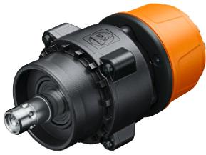
Tête de taraudage avec commutation mécanique gauche/droite. Taraudage rapide et efficace jusqu'à M14. Pas de commutation gauche/droite nécessaire pendant le taraudage. Compatible avec toutes les visseuses sans fil FEIN dotées de l'interface QuickIN / QuickIN MAX.
