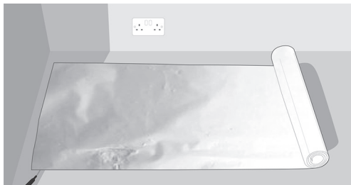
Рис. 5. Монтаж нагревательного мата
