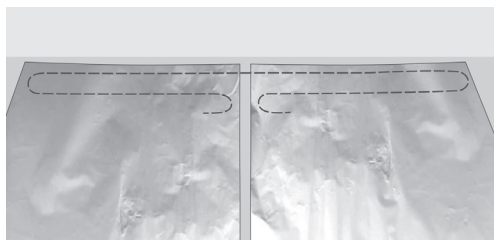
Joonis 6. Rullige matt lahti, lõigake fooliumit ja keerake tagasi
