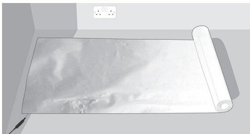
5. att. Apsildes paklāja uzstādīšana
