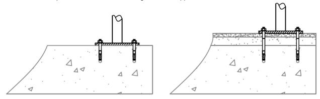
Pour les fixations sur des terrasses revêtues de lames de bois, il est vivement conseillé de réaliser une fixation traversante prenant en pince la platine et la lame de bois avec des boulons (ensemble vis + écrous) et des rondelles larges sous la face inférieure de la lame. En parallèle, vérifiez que les lames soient également **solidement** fixées à leur support.
