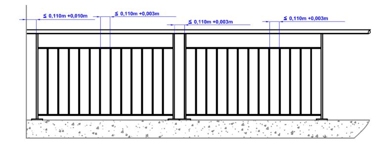
La NF P 06-111-02 / Eurocode 1 (norme des charges d'exploitations des ouvrages du bâtiment) définie plusieurs cas de charges possibles des garde-corps en fonction de son lieu d'installation :
