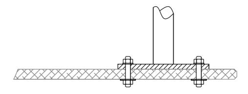
Pour la fixation des main-courantes en bout des garde-corps, vous pouvez utiliser des chevilles en nylon (type S, SX, UX) avec des vis à panneaux sans pointes coupantes, dans les tableaux de maçonnerie pleine, ou des scellements chimiques avec tamis et tiges filetées dans les maçonneries creuses.
