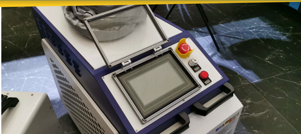
Protection écran tactile anti-choc pour l'atelier et poignées de chargement pour déplacement en clientèle
