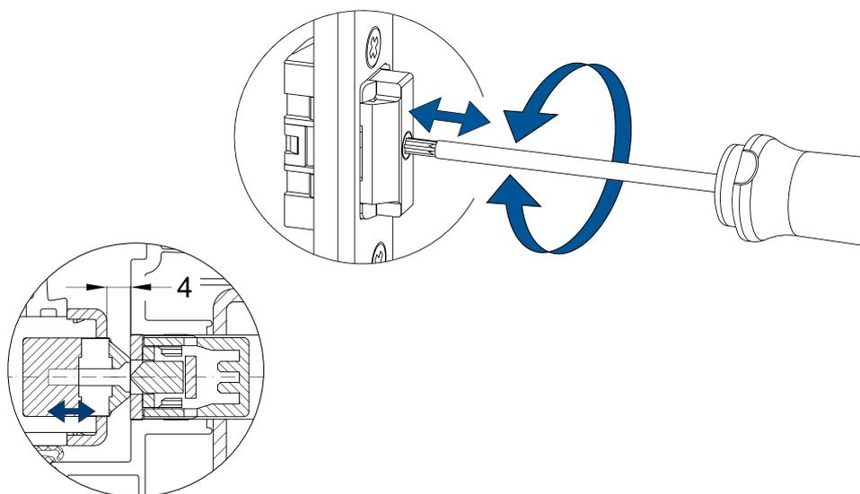
Sortir la vis d'environ 4 mm jusqu'à ce que le déclencheur T-G1 AVP touche la têtère de la serrure (vantail de porte est fermé) et déclenche la serrure. Jeu de feuillure recommandé 4 mm (dépendant du système)
