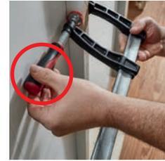
Le serrage devant une surface fermée n'est pas possible en raison du positionnement de la poignée des outils de serrage classiques, car la poignée ne peut pas être actionnée.
