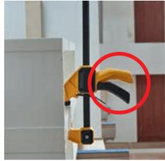
Le risque d'endommager la pièce à usiner et de se blesser augmente dans les espaces de travail réduits, si des dispositifs de serrage sont utilisés avec des composants saillants.
