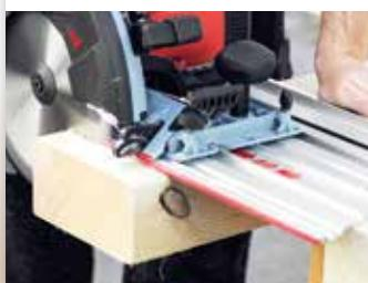
Le dispositif de guidage en L trouve une application optimale dans le domaine de la construction pour le sciage de bois, jusqu'à 82 mm de profondeur de coupe et 370 mm de longueur de coupe.
