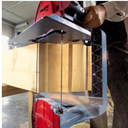
Grâce aux couples de rotation élevés, le Z 5 Ec ne rencontre pas la moindre difficulté dans le bois massif avec une profondeur de coupe de 305 mm.
