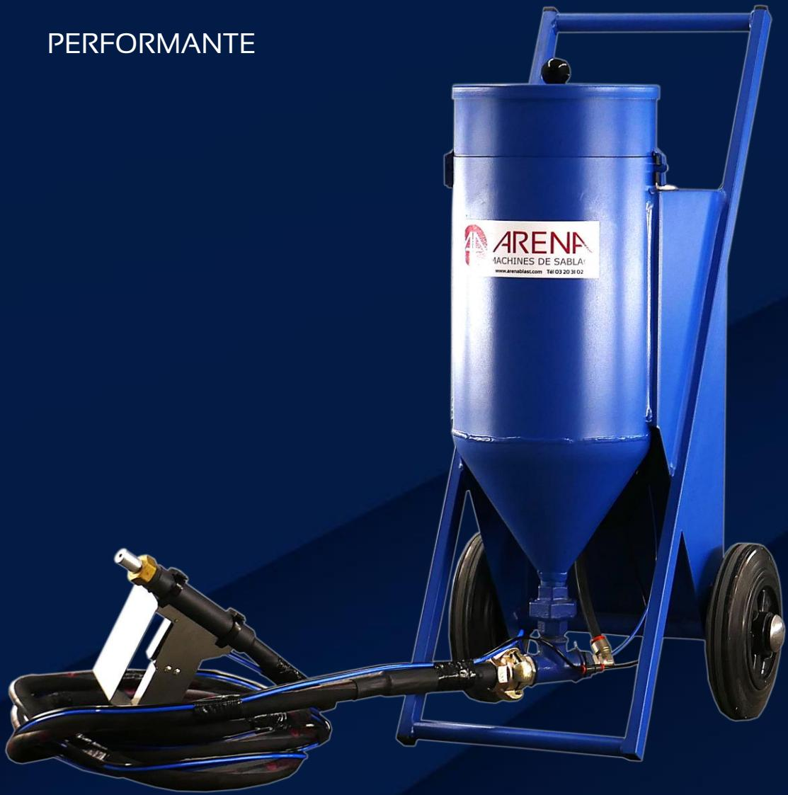
**La sableuse mobile NS8T E , est une aéro-gommeuse à surpression qui permet des opérations de sablage à haute intensité. Le pot sous pression de 8 L permet des traitements de surfaces 3 à 5 fois plus rapide qu'avec un système basique à dépression/succion. Effectivement l'abrasif est projeté avec beaucoup plus de vitesse et de rendement.**
