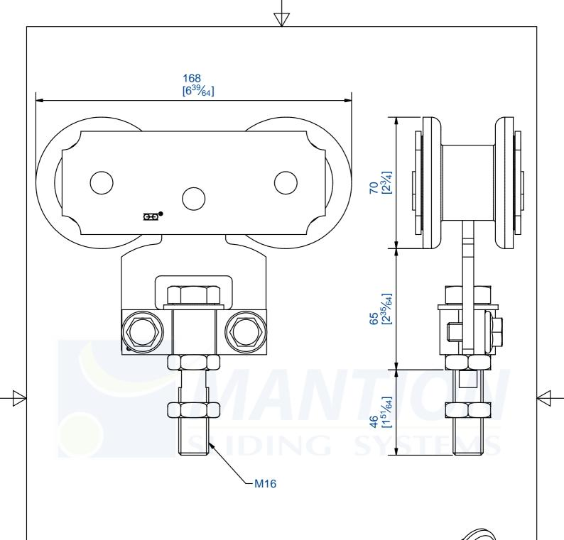
Monture fixation sur chant, 2 galets acier sur cages à rouleaux. Capacité : 600 Kg par panneau
