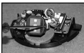
Retirer délicatement l'élément de fixation ainsi que l'antenne lobe large.
