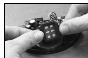
Fixer la nouvelle antenne sur son support avec l'élément de fixation.
