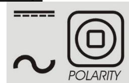
Cette icône permet de régler la polarité du procédé de soudage à utiliser : à l'électrode enrobée CC+ et CA, TIG CC- et CA.
