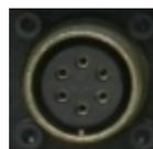
Voir la section Accessoires pour connaître les références de commandes à distance utilisables. Si une commande à distance est utilisée, elle devra être branchée sur la prise de commande à distance située sur le panneau frontal du poste. L'appareil détecte automatiquement la commande à distance, la LED REMOTE s'allume et le poste passe en mode « à distance ». Voir plus loin pour plus d'informations.
