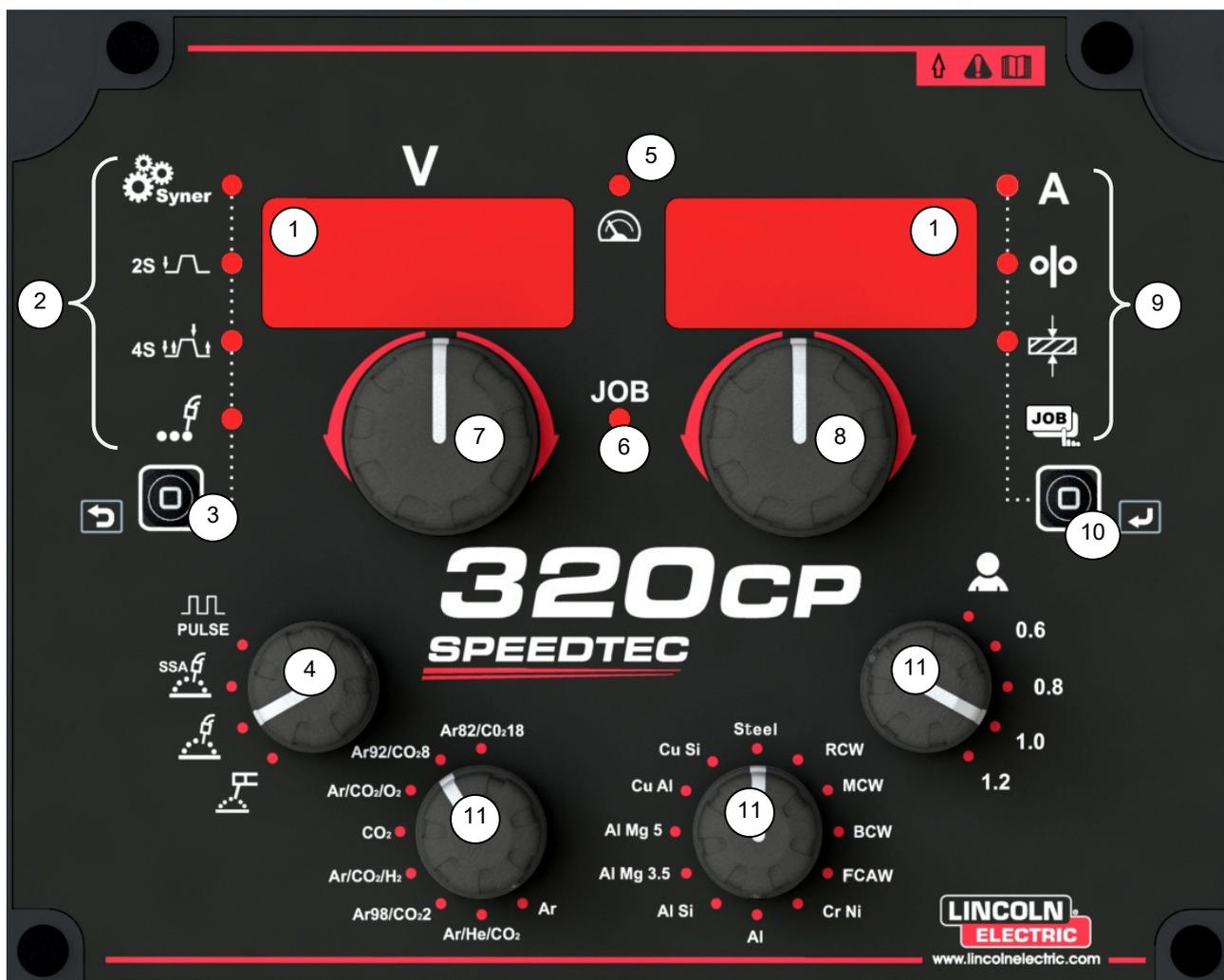
Afficheur gauche tension, Afficheur Droit : courant /vitesse fil/ épaisseur
