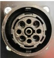
Le **COOLARC 46** est alimenté par une source d'alimentation de soudage en utilisant une prise à 9 broches.
