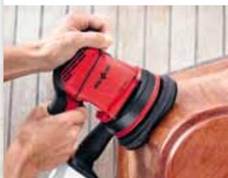
Le plateau souple permet un excellent nivellement, et garantit une finition inégalée, y compris pour les surfaces concaves et convexes. Le support en mousse compense les inégalités et confère ainsi une finition de surface très régulière.
