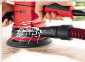
L'extraction puissante intégrée, allié aux disques multi-perforés, permet de travailler de manière sûre et quasiment sans poussière. Le disque abrasif ne se colmate pas, la consommation d'abrasif baisse, le résultat du travail s'améliore.
