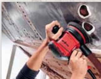
Pour le ponçage grossier, il convient de choisir le modèle EVA 150 E / 5. Son mouvement oscillant possède une course de 5 mm et une vitesse de 12 000 tr/min, pour un résultat optimal.
