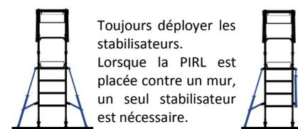
Toujours déployer les stabilisateurs. Lorsque la PIRL est placée contre un mur, un seul stabilisateur est nécessaire.
