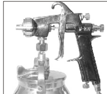
Jet plat vertical (chapeau horizontal)
