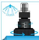
4 - Désserrez la bague 4 puis agir sur le sélecteur 5 afin de régler la course des bras 3 nécessaire au bon sertissage de l'insert. Refermez les bras jusqu'en butée pour sertir.
