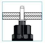
4 - Insérez la tige du rivet dans le nez 2 de la pince et le corps du rivet dans le percement des éléments à assembler.
