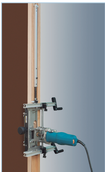
Entaillage du dormant, 2 ème paumelle.
