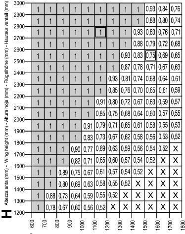
PORTATE MASSIME - MAXIMUM LOADS - CAPACIDADES MAXIMÁS CHARGES MAXIMUM - TRAGFÄHIGKEITEN
