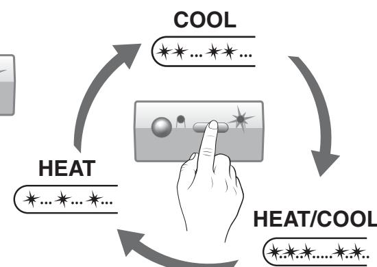
Choix du mode (appuis brefs) / Mode selection (press and release) / Modusauswahl (kurzer Tastendruck) / Scelta della modalità (pressioni brevi) / Selección del modo (pulsaciones breves) / Wybór trybu (krótkie naciśnięcia) / Keuze van de modus (kort indrukken)
