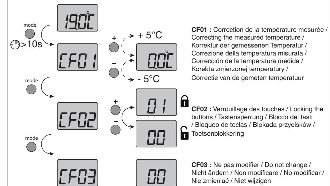
**CF01** : Correction de la température mesurée / Correcting the measured temperature / Korrektur der gemessenen Temperatur / Correzione della temperatura misurata / Corrección de la temperatura medida / Korekta zmierzonej temperatury / Correctie van de gemeten temperatuur
