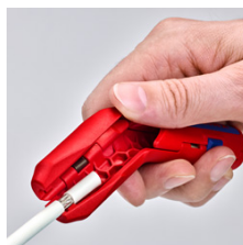
Dégainage d'un câble coaxial
