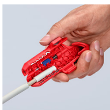
Dégainage d'un câble NYM
