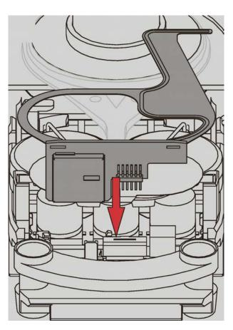
5. Appuyez fermement sur le nœud réseau jusqu'à ce que le bec de blocage en plastique s'enclenche dans le logement métallique du nœud réseau.
