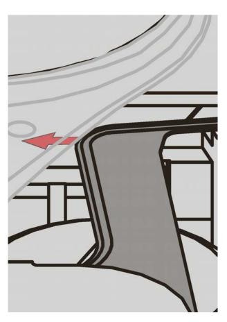
7. Poussez l'extrémité de la platine flexible sous le logement prévu à cet effet.
