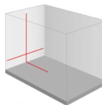
Laser de ligne avec 1 ligne rouge horizontale et 1 verticale. Nivellement pendulaire avec une précision de 3,5 mm/10 m et une portée de 40 m avec récepteur (en option).
