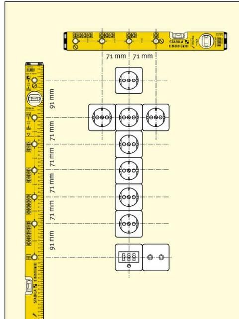
Profilé rectangulaire avec trous de marquage. Embouts avec taquets antigliss des 2 côtés. 1 Fiole horizontale et 1 fiole verticale.
