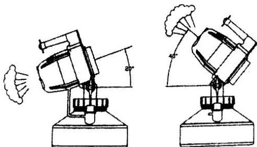
La tête peut avoir un angle de 60 degrés, qui peut être positif de 40 degrés vers le haut et négatif de 20 degrés vers le bas. Ajustez rapidement l'angle avec le dispositif de verrouillage rapide.
