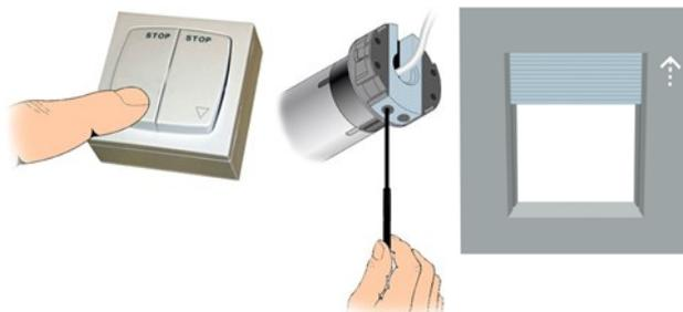
2) Couper l'alimentation du moteur et tourner lentement la clé de réglage dans le même sens
