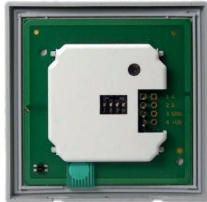
Ce lecteur doit être connecté via les bornes suivantes à l'AccessManager® au terminal AccessManager ENiQ :
