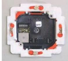
La flèche du marquage Top sur le module arrière doit être dirigée vers le haut.
