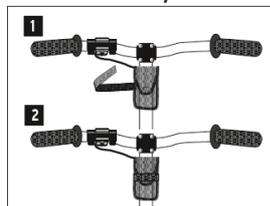
Fixation de la lampe sur le guidon
