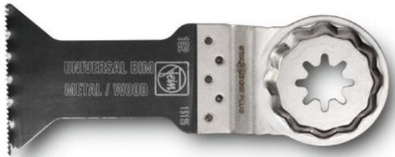
Bi-métal avec denture universelle avoyée. Large gamme d'utilisations pour tôles jusqu'à 2 mm, profilés en aluminium, tubes de cuivre, bois, plaques de plâtre et plastiques.
