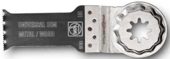
Bi-métal avec denture universelle avoyée. Large gamme d'utilisations pour tôles jusqu'à 2 mm, profilés en aluminium, tubes de cuivre, bois, plaques de plâtre et plastiques.
