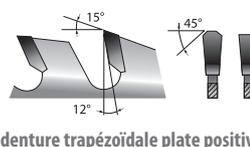
Lame carbure pour une coupe de finition et la mise à format. État de surface lisse, raboté, sans éclats notamment dans les coupes d'angles.
