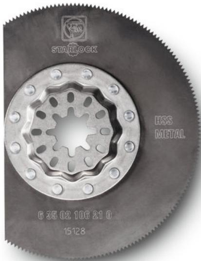
Lame de scie HSS pleine avec denture en métal pour tôles jusqu'à env. 1 mm. Également pour plastiques, résines composites, bois, mastic et métaux non ferreux. Excellente vitesse de coupe. Ligne de coupe nette et fine.
