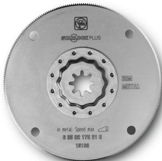
Bi-métal pour une durée de vie élevée. Denture en métal pour tôles jusqu'à 1 mm. Également pour plastiques, résines composites, bois, mastic et métaux non ferreux. Plat pour travaux de surface. Rendement optimal grâce à la lame circulaire et le diamètre ultra large.
