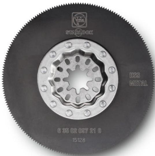
Lame de scie HSS pleine avec denture en métal pour tôles jusqu'à env. 1 mm. Également pour plastiques, résines composites, bois, mastic et métaux non ferreux. Excellente vitesse de coupe. Ligne de coupe nette et fine.
