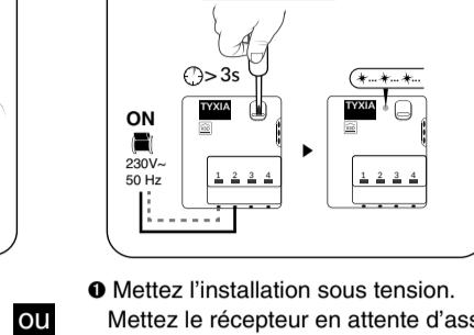
**FR** ① Mettez l'installation sous tension. Mettez le récepteur en attente d'association (voir notice récepteur).
