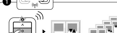
Association commande individuelle ou centralisée (16 moteurs maximum) / Individual or centralized control association (16 motors maximum) / Zuordnung Einzelsteuerung oder zentrale Steuerung (von bis zu 16 Motoren) / Associazione comando individuale o centralizzata (fino a 16 motori max.) / Asociación control individual o centralizado (hasta 16 motores) / Przypisanie maksymalnie 16 silników / Koppeling individueel of gecentraliseerd commando (tot maximaal 16 motoren)
