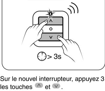
**FR** ② Sur le nouvel interrupteur, appuyez 3 secondes sur les touches et .
