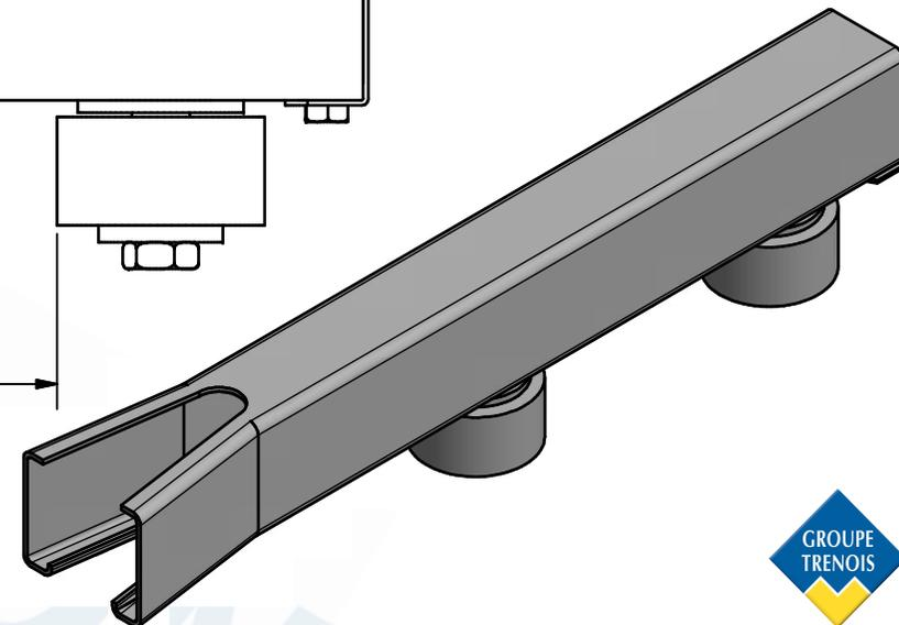
Guide supérieur réglable a sceller pour porte roulant sur rail au sol , 2 olives montées sur cage à rouleaux
