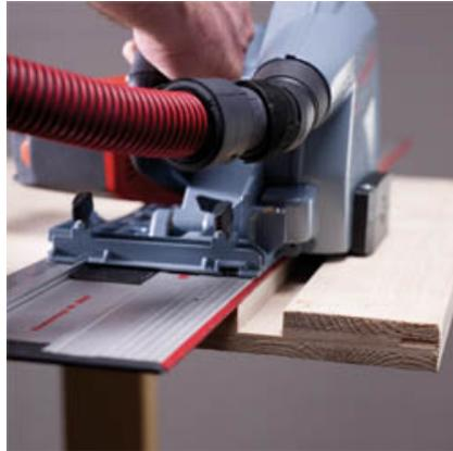
Avec le MF-VN 25, il est possible de fraiser des rainures pour réaliser des cachesmoineaux ou des conduits d'alimentation.
