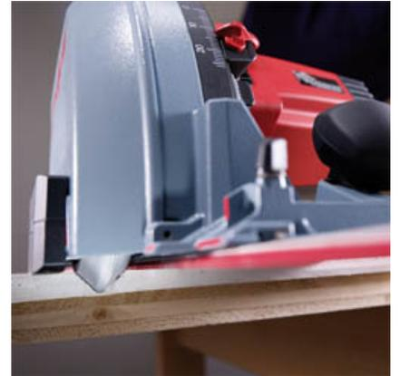
Avec le MF-GF 90/15, il est possible de fraiser des rainures en V à 90° en produisant peu de poussière. Une pose de colle en fin de processus permet de réaliser en quelques étapes un revêtement d'angle stable.
