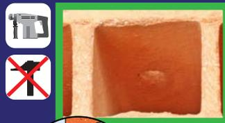
• Le trou est propre en entrée et en sortie.
