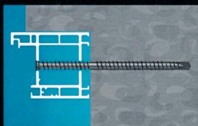
Ø 6.5 pour Fixation avec vis béton
