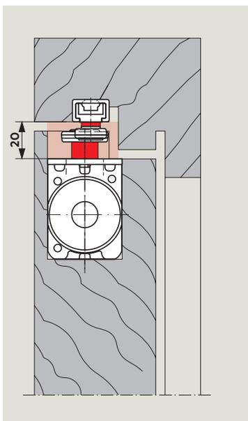
Porte métallique à recouvrement avec huisserie acier, jeu de traverse haute de 12 mm, avec ITS 96/ITS 96 FL EN 3-6, axe rallongé de 4 mm et glissière G 96 EMF K8.
