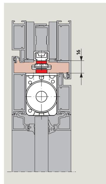
Porte bois avec huisserie à double feuillure, jeu de traverse haute de 20 mm, avec ITS 96/ITS 96 FL EN 3-6, axe rallongé de 8 mm et glissière G 96 N20 K12.
