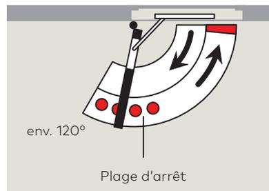
Le dispositif d'arrêt **RF** détermine un point d'arrêt précis, sans recul de la porte, jusqu'à un angle d'environ 120°. La force de rétention est réglable en fonction de la largeur de porte. Le dispositif d'arrêt RF est réversible droite-gauche. Il s'installe dans une glissière G 96 N20.
