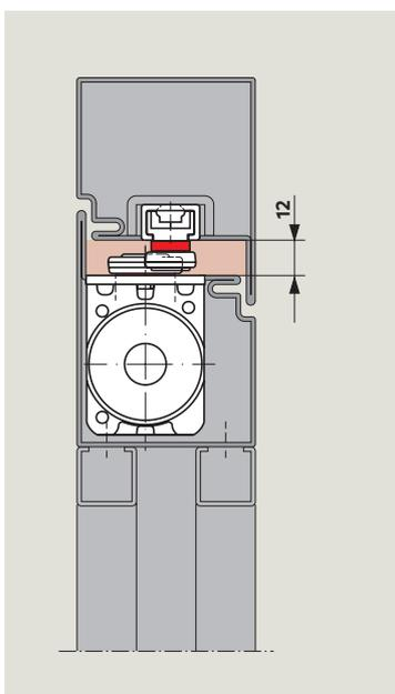
Porte à fleur en profilé aluminium, jeu de traverse haute de 16 mm, avec ITS 96/ITS 96 FL EN 3-6, axe rallongé de 4 mm et glissière G 96 N20 K12.
