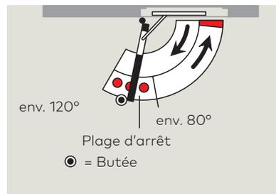
La glissière détermine un point d'arrêt précis, sans recul de la porte. Le point d'arrêt est réglable entre 80° et 120° environ.
