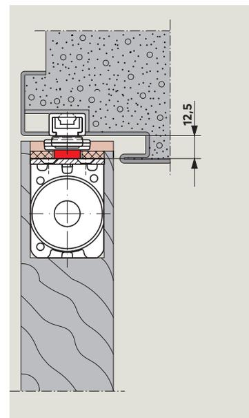
Porte à fleur en profilé acier, jeu de traverse haute de 12 mm, avec ITS 96/ITS 96 FL EN 3-6, axe standard et glissière G 96 N20 K12.
