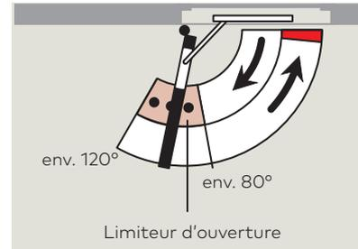
La glissière comprend: bras, glissière, coulisseau, limiteur d'ouverture et vis de fixation. Elle s'adapte aux ferme-portes ITS 96 force 2-4 et ITS 96 force 3-6.
