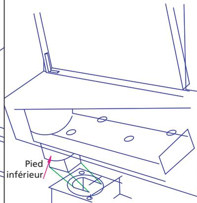
3- Ajuster l'axe de la penture supérieure à l'aide d'un tournevis, fixer alors la porte en place.
