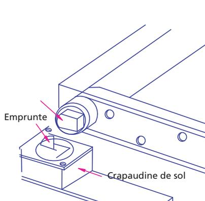
2- Faites pencher la porte de façon à pouvoir insérer entièrement le pied inférieur dans la crapaudine de sol. Levez alors la porte à la vertical.
