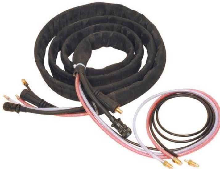
Jeu de câbles d'interconnexion refroidis par air de 10 m : câble de soudage 70 mm<sup>2</sup> avec TM (Mâle + Femelle), tuyau de gaz, câble de commande ArcLink 5 broches, gaine de protection. Pour Powertec-iS / Digisteel S / Citosteel S et le nouveau Speedtec 400SP/500SP.
